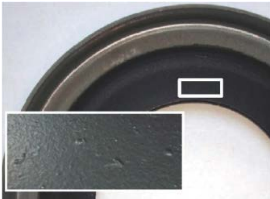
图 2>粘接涂层表面粗糙，电磁感应接触式膜厚仪的测量偏差较大
