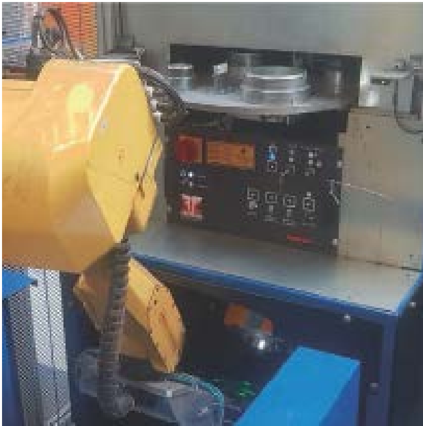
图3 >在 AAM Lyon，生产的每个扭转减振器都是使用涂魔师进行涂层厚度测量。将厚度等生产参数激光扫描成二维码。
