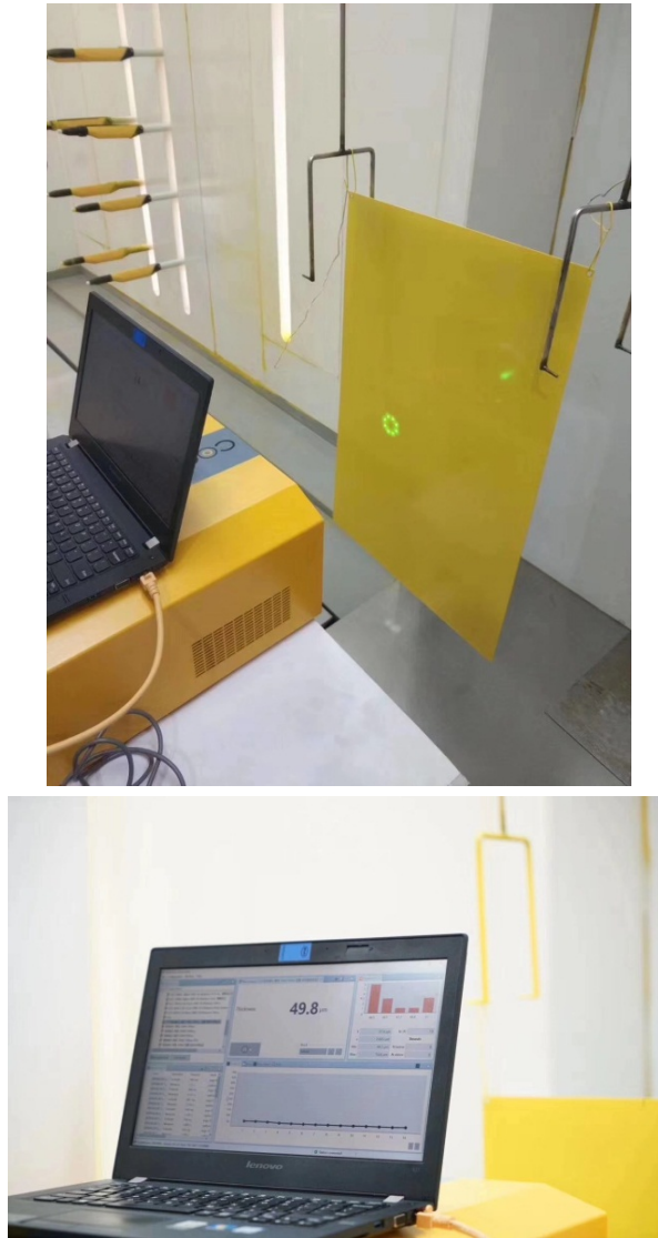
图表 2：使用电磁感应测厚仪测量样品干膜数据
